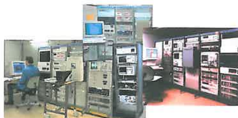
ATE31, ATE33, ATE36 samt ATE37 för test av JAS 39-elektronik.
