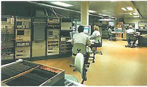
Test av apparater för JAS 39 A + B på AerotechTelub verkstad.
