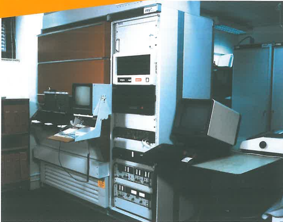
Digital ATE LPA10302 för test av kretskort i både JAS 39 och ERICSSON AXE telefonsystem.
